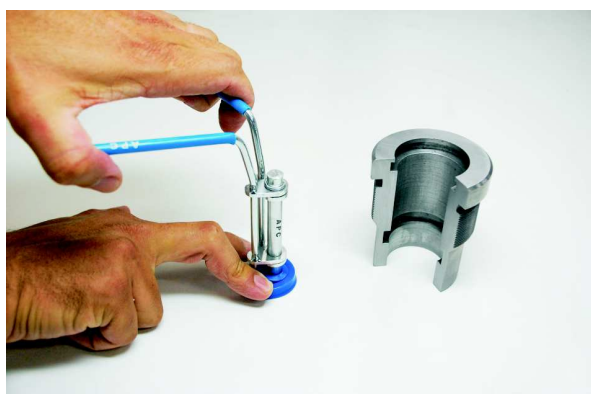
3) Posicionando a gaxeta e travando o alicate
